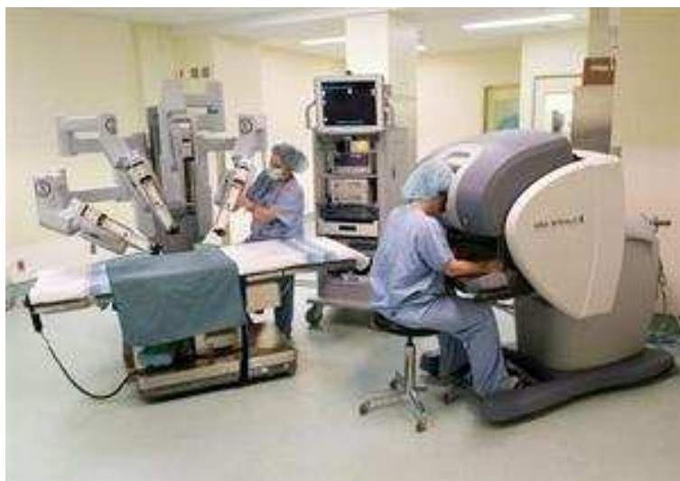
Figure 1: Système da Vinci à quatre bras avec télémanipulateur, colonne technique et console de
